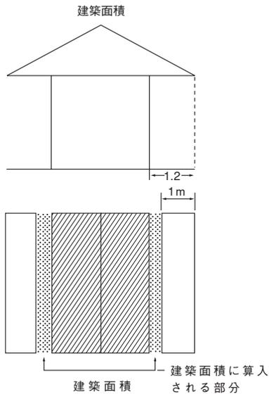
建築面積とは建築物の外壁・柱の中心線で囲まれた部分の面積です。但し、軒、ひさし、バルコニー等でこの中心線より1m以上突き出た所があるときは、先端より1m後退した部分までは建築面積に算入されます（建築基準法施行令第2条）。
